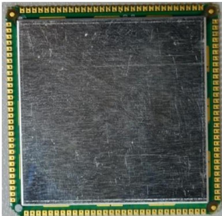
图 3-2 GSC328X 核心板实物图(正面带屏蔽罩)
