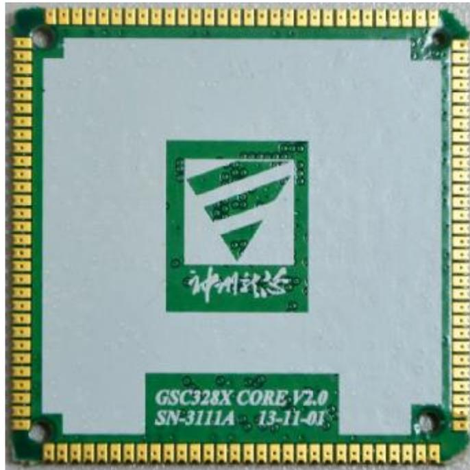
图 3-3 GSC328X 核心板实物图(背面)
