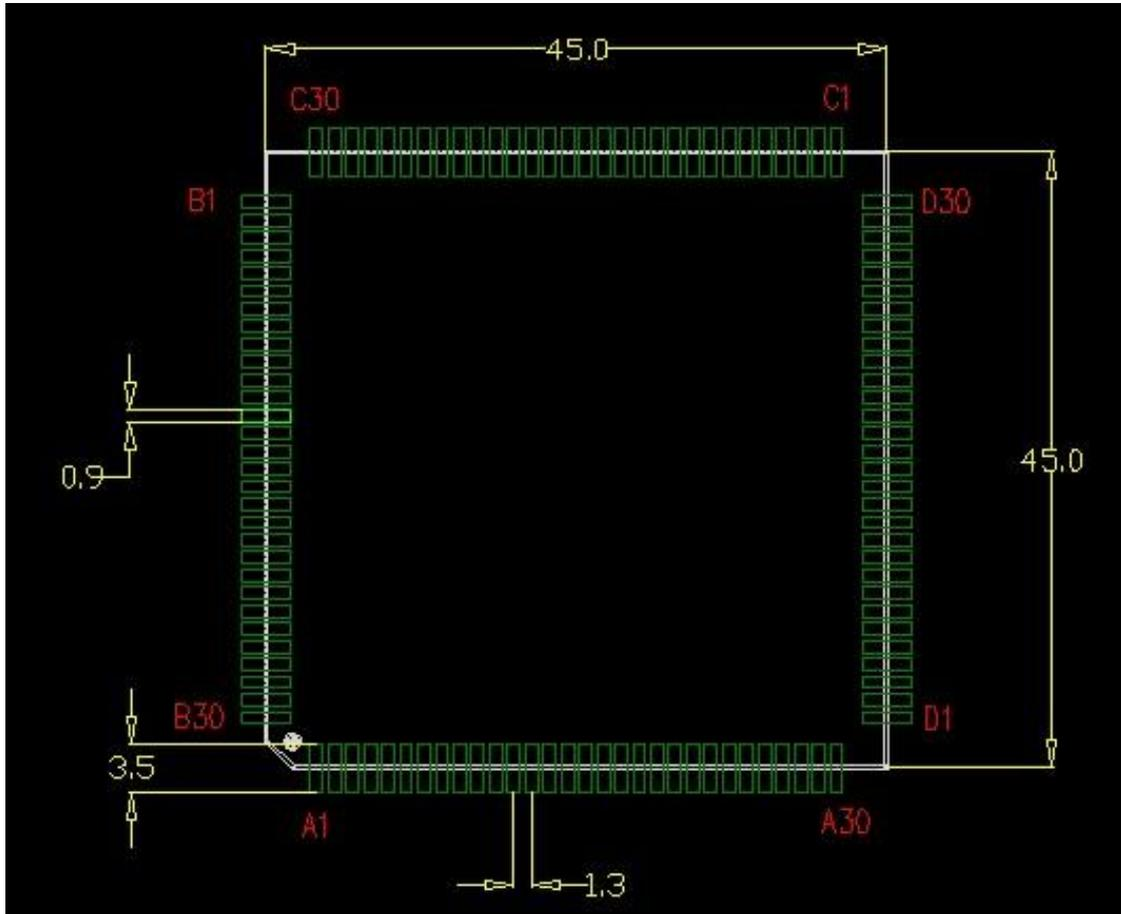
图 5-4 GSC328X 核心板推荐封装尺寸图
