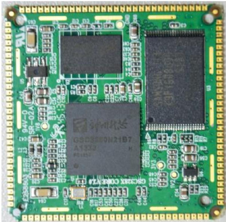
图 3-1 GSC328X 核心板实物图(正面)
